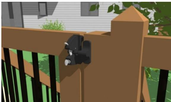
Exemple de loquet permettant à la porte de se verrouiller automatiquement. La porte devrait aussi être munie de peinture à ressort afin de se refermer automatiquement.
